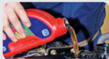
1.21. La viscosidad del aceite es la característica más importante de la lubricación de cualquier máquina. Si ésta es muy baja, el desgaste de la máquina será mayor y si es muy alta, el aceite se calentará por fricción.
