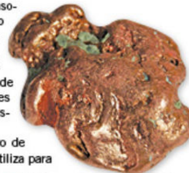
2.52. El cobre presenta valencias 1 y 2, y puede perder el electrón de la órbita de valencia para formar un átomo con mayor estabilidad. Al perder el electrón, adquiere carga positiva; ésta es la razón de su conductividad térmica y conductividad eléctrica.
